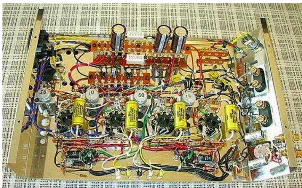
JENSEN コンデンサー換装後の内部配線全景
