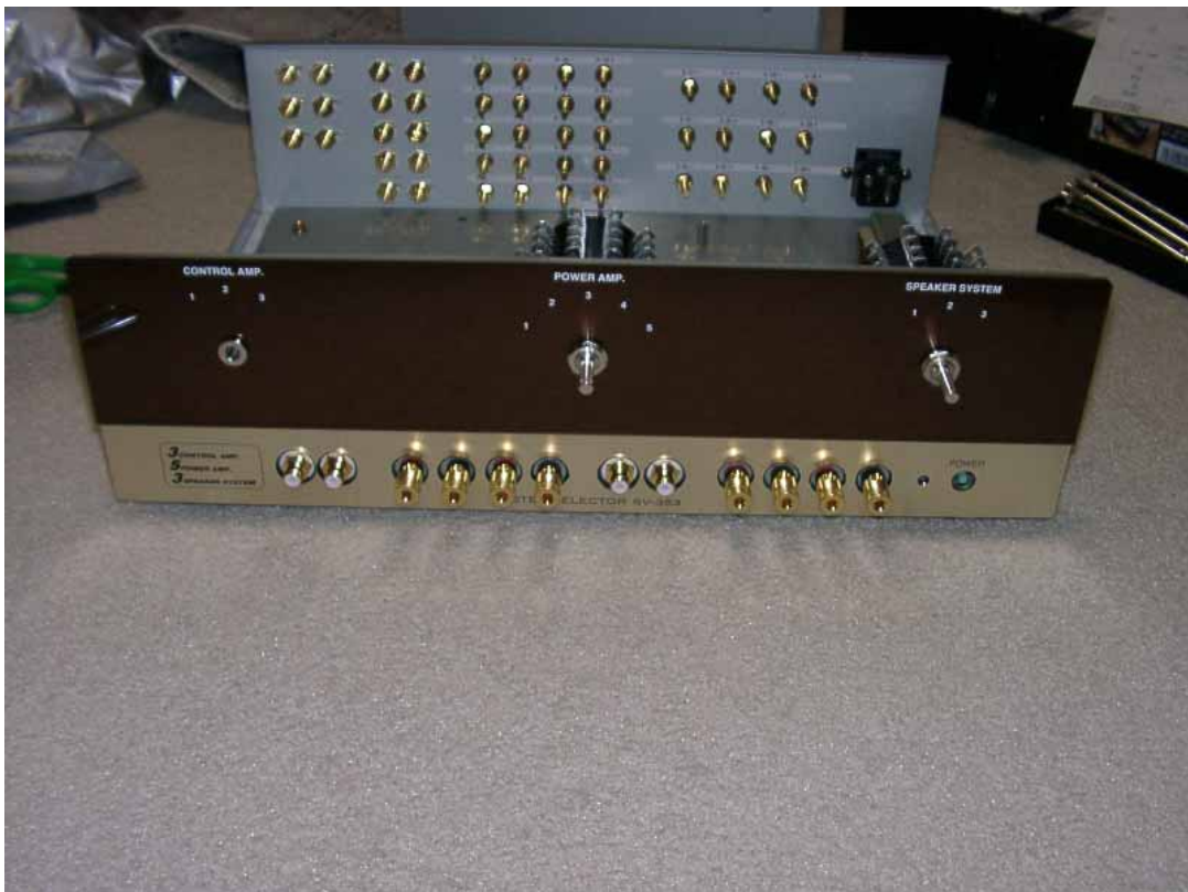
(写真5 端子類取付完了)
