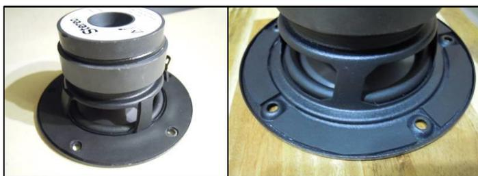
図1.4. 防振材によるフレームの鳴き止め
