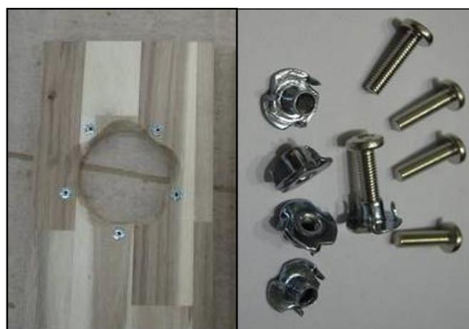
図 4. バッフル板の面取り加工と爪付ナット打込み
