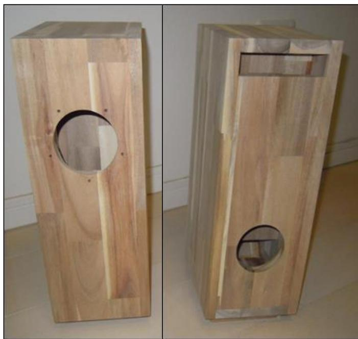
図7. バッフル板の接着と組立完成状態（表面処理なし）
